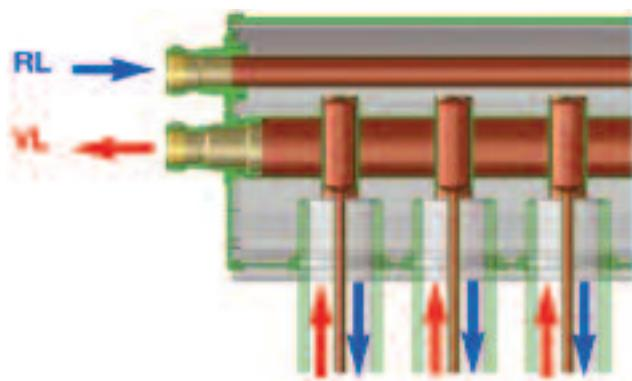
Непосредственно вакуумная трубка напоминает конструкцию термоса, где одна трубка вставлена в другую, большего диаметра. Трубки выполнены из особого ударопрочного стекла, выдерживающего удары крупных градин.
