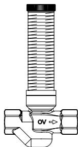
с обеих сторон внутренняя резьба по EN 10226-1 для универсального присоединения труб при скрытой установке, напр. под штукатуркой и внутри строительной конструкции, со специальной гильзой и колпачком для защиты/обслуживания
