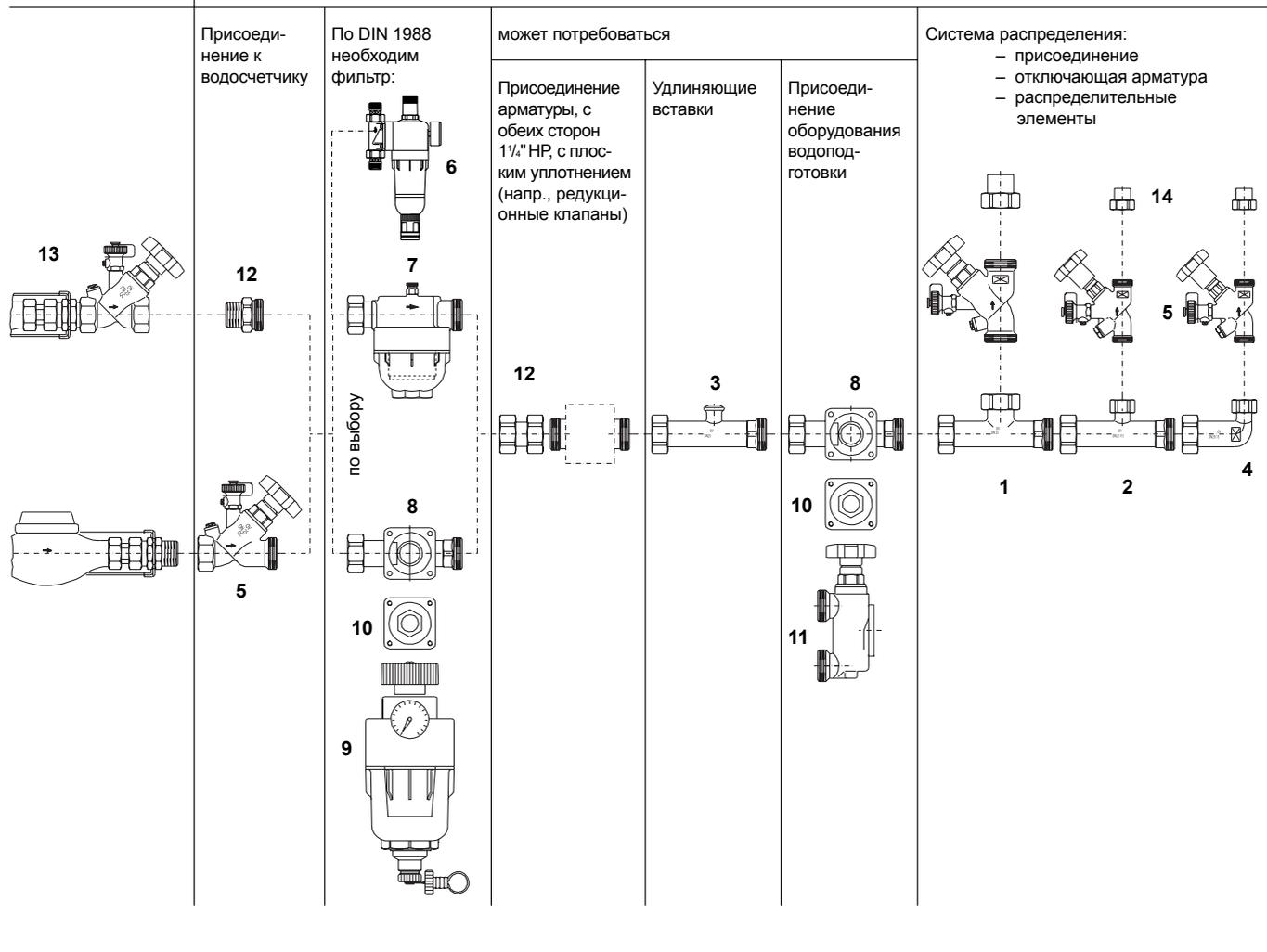
Распределительная система водоснабжения Oventrop из бронзы (PN 16) позволяет осуществить быстрый монтаж. Компоненты надежно соединяются между собой за счет плоского уплотнения.
