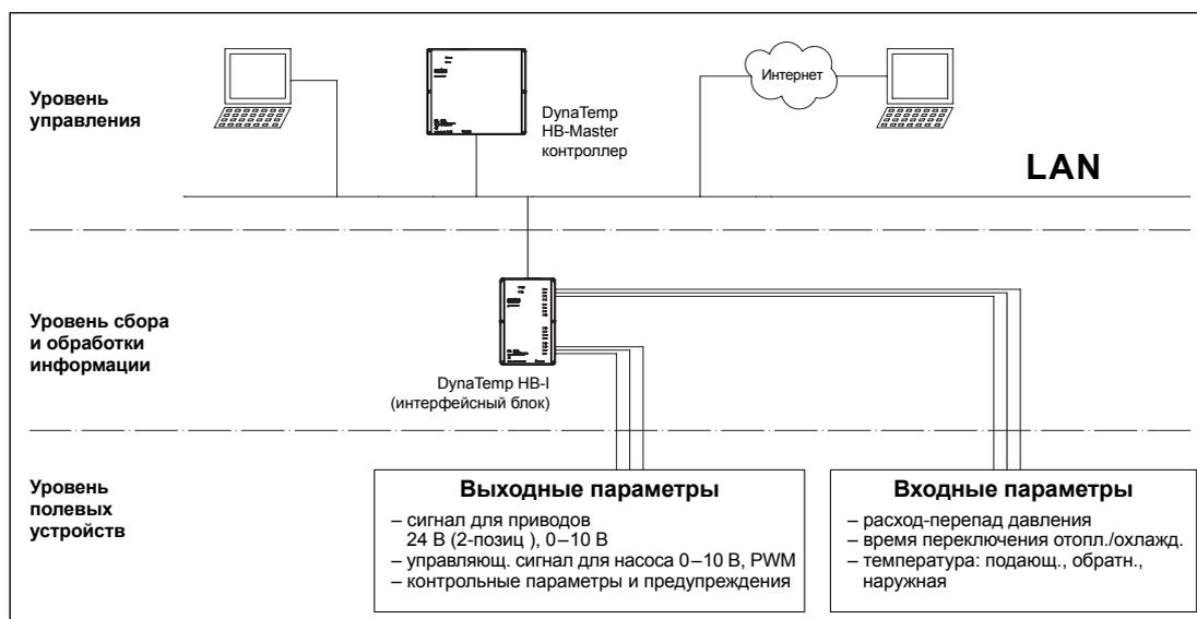
**„DynaTemp WB“ - центральное регулирование и контроль циркуляционных систем водоснабжения**
