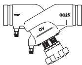
**„Hydrocontrol VGC“ (преднастраиваемый, с желобом под соединительную муфту, из серого чугуна)**
