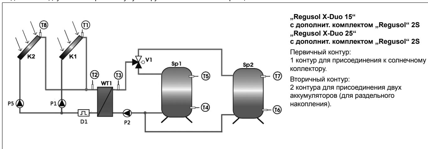
Подключение двух коллекторов к двум аккумуляторам тепла при раздельном накоплении
