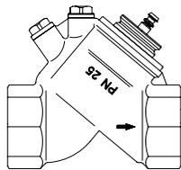
**„Hydrocontrol ETR“ (под привод, резьбовой, бронзовый)**
