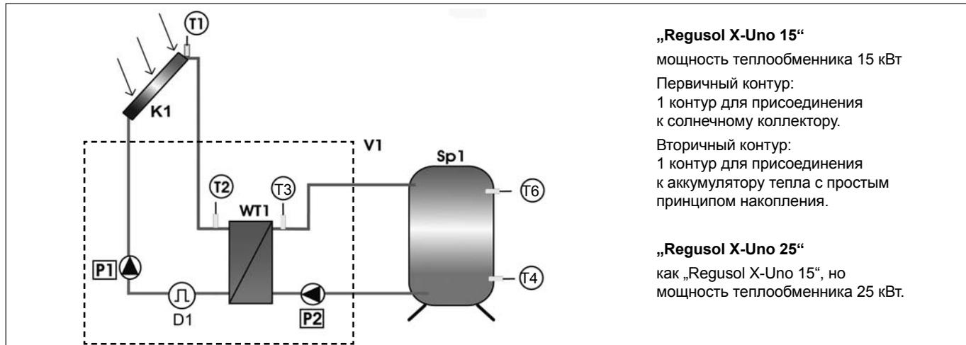
Подключение аккумулятора тепла с простым принципом накопления
