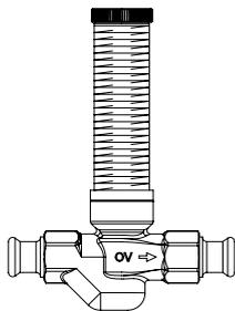
с обеих сторон бронзовое прессовое соединение для универсального присоединения труб при скрытой установке, напр. под штукатуркой и внутри строительной конструкции, со специальной гильзой и колпачком для защиты/обслуживания
