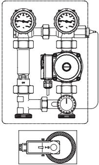
**6.с „Regumat F/FR“ станции для регулирования панельного отопления****Содержание**
