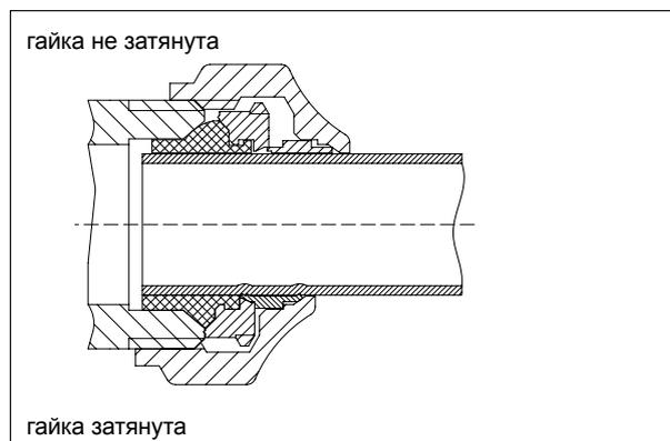
Присоединительный набор со стяжным кольцом „Ofix CEP” Klack & Klemm для медной, прецизионной стальной и трубы из нержавеющей стали, мягкое уплотнение, наружная резьба
