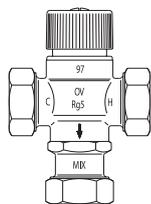
корпус из бронзы, прочие части из латуни, стойкой к выщелачиванию цинка (EZB) резьбовые соединения из латуни наружная резьба G 1 с 3 накидными гайками Ду 20 G 1 x G 1 x G 1
