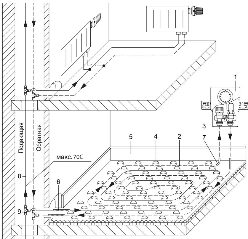
**Система панельного отопления „Cofloor“ с монтажным набором „Unibox E plus“ для регулирования температуры отдельного помещения**
