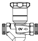
с обеих сторон наружная резьба по DIN ISO 228, плоское уплотнение, для установки в перекрытии, фиксированная настройка температуры 57 °C ± 1 °C
