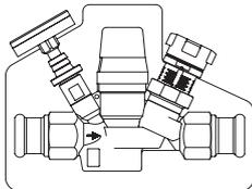
С функцией отключения, преднастройки, но **без** штуцера для шланга перед термостатическим элементом, **без** термометра и **без** изоляции.
