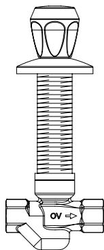
с обеих сторон внутренняя резьба по EN 10226-1 для универсального присоединения труб при скрытой установке под штукатуркой, с хромированным маховиком
