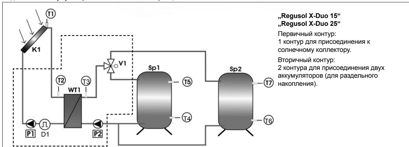
Подключение двух аккумуляторов тепла при раздельном накоплении
