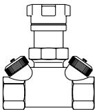
с обеих сторон вентильные вставки для измерения/слива с изолирующими пластинами
