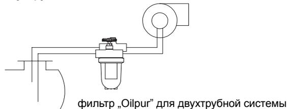
Подающий и обратный топливопроводы к емкости; расход топлива соответствует мощности насоса горелки.
