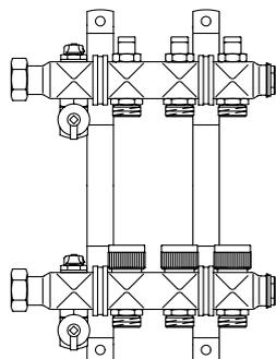
**„Multidis SF“ гребенка из нержавеющей стали 1" для панельного отопления со встроенными регулируемыми вставками на подаче**
