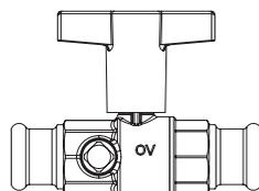
с обеих сторон бронзовое прессовое соединение с двусторонним расположением дренажных отводов G 1/4, закрыты заглушками, для универсального присоединения труб
