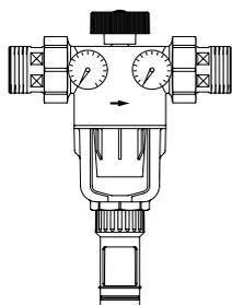
**Фильтр для очистки воды „Aquanova Compact R“ с функцией обратной промывки с прозрачной пластмассовой чашкой (Трогамит) PN 16**
