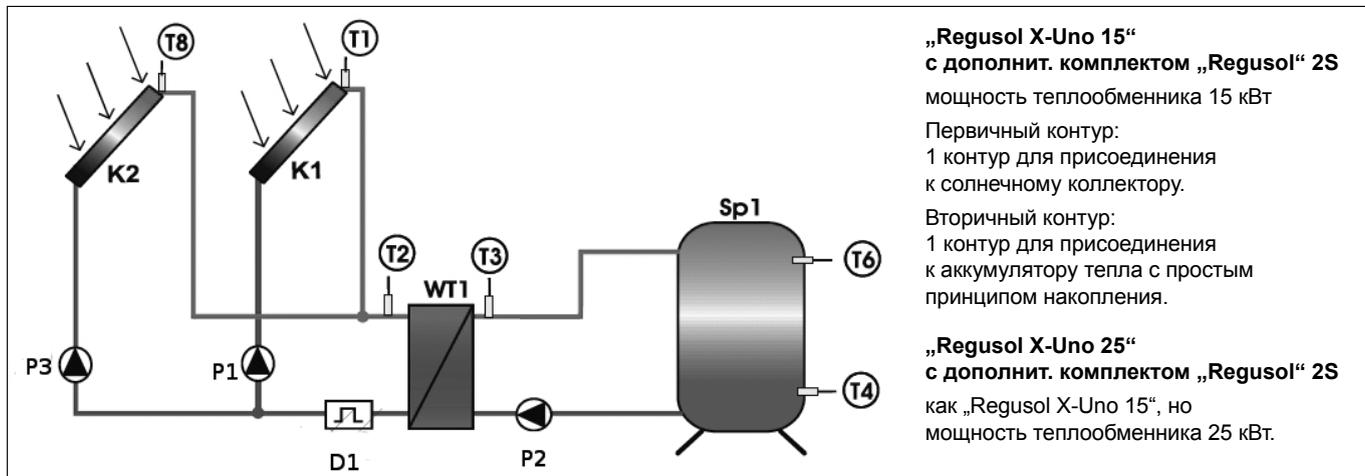
Подключение двух коллекторов к аккумулятору тепла с простым принципом накопления
