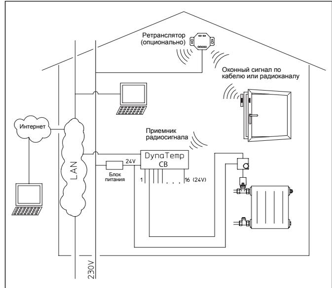
Система „DynaTemp CB“ с управлением электрическими комнатными термостатами и сервоприводами на отопительных приборах.
