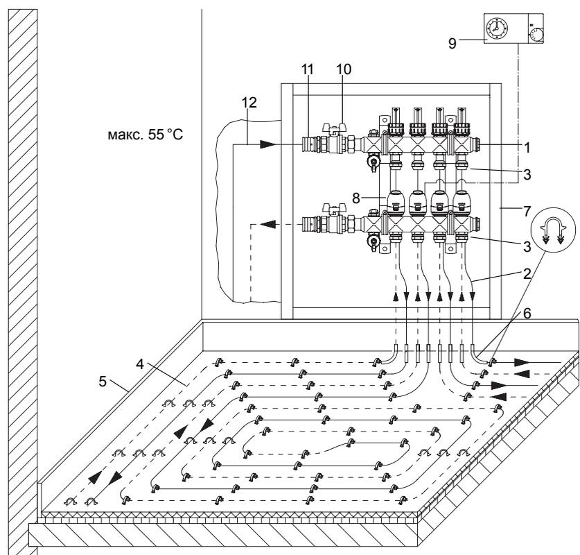
**Система панельного отопления и охлаждения „Cofloor“ со стальной гребенкой „Multidis SF“**
