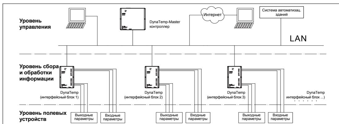
Программное обеспечение контроллера с одной стороны и входы/выходы интерфейсного блока с другой стороны приспособлены для различных требований систем отопления, водоснабжения и охлаждения.
