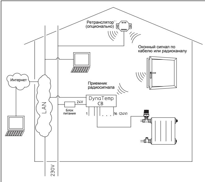
Система „DynaTemp CB“ с управлением термостатами отопительных приборов „Uni LHZ“
