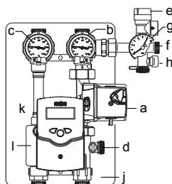
рис.: контроллер OV-„Regtronic BS/2“
