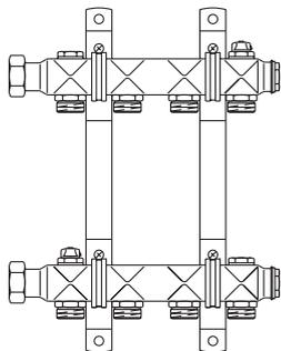
**„Multidis SH“ гребенка 1" из нержавеющей стали для присоединения отопительных приборов с плоским уплотнением**
