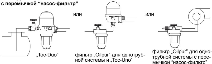
Только подающий топливопровод к емкости, расход топлива соответствует мощности форсунки (отопительная нагрузка в 1 кВт соответствует мощности форсунки в 10 л/ч). Насос горелки с подключением подающего и обратного топливопроводов. Для бесперебойной работы горелки рекомендуется применять автоматическое удаление воздуха через „Тос-Duo“ или „Тос-Uno“.
