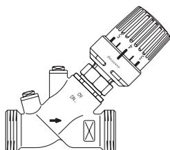
Системы питьевого водоснабжения PN 16, для циркуляционных трубопроводов. Температура воды макс. 90 °С, диапазон настройки 30 – 70 °С, настройка может быть заблокирована и ограничена, шкала настройки 3 – 7. Контактующие со средой части арматуры не содержат латуни. Шаровой кран для слива см. комплектующие.
