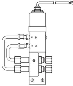
**Преобразователь перепада давления „OV-Connect“**
