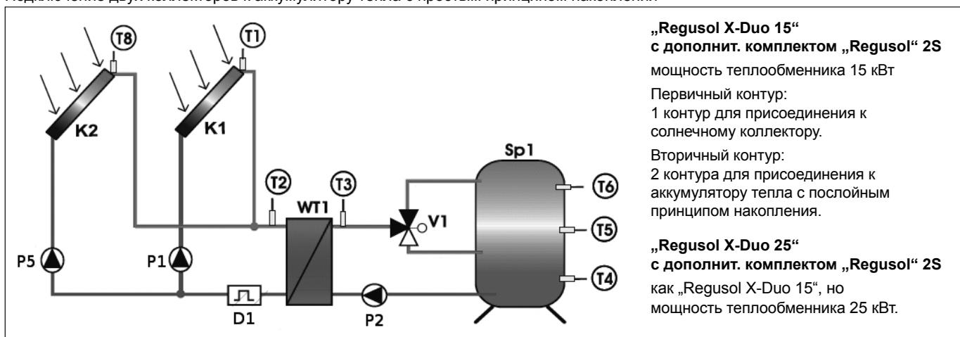
Подключение двух коллекторов к аккумулятору тепла с послойным принципом накопления
