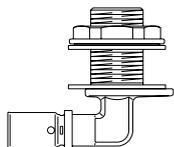
**Прессовый угольник 90° для прохода через стену, с крепежным комплектом G 3/4**
