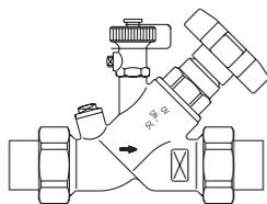
с обеих сторон наружная резьба по DIN ISO 228 с уплотнительными кольцами, накидными гайками и втулками под пайку (бронза) с шаровым краном для слива для присоединения медной трубы
