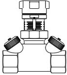
с обеих сторон вентильные вставки для измерения/слива с изолирующими пластинами
