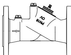
**„Hydrocontrol EFC“ (под привод, фланцевый, из серого чугуна)**
