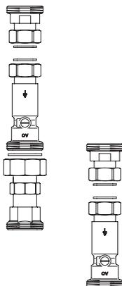
**Набор для монтажа теплосчетчика**
