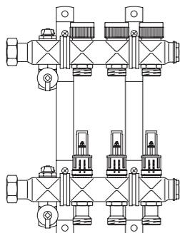
**„Multidis SF“ гребенка из нержавеющей стали 1" для панельного отопления со встроенными ротаметрами 1-4 л/мин.**
