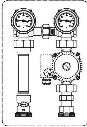
**6.a „Regumat“ - станции для подключения источника тепла к отопительному контуру****Содержание**
