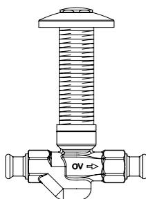
усиленная модель, с обеих сторон бронзовое прессовое соединение для универсального подключения труб при скрытой установке под штукатуркой, с хромированной защитной крышкой и ключом с внутренним шестигранником SW5 для обслуживания
