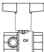
**Шаровые краны для систем водоснабжения „Optibal TW“ PN 10**
