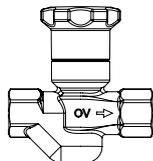
с обеих сторон внутренняя резьба по EN 10226-1 для установки в перекрытии фиксированная настройка температуры 57 °C ± 1 °C
