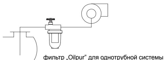
Как однотрубная система с переключкой „насос-фильтр“, однако к насосу горелки подключен только всасывающий трубопровод (это возможно не для каждого насоса).
