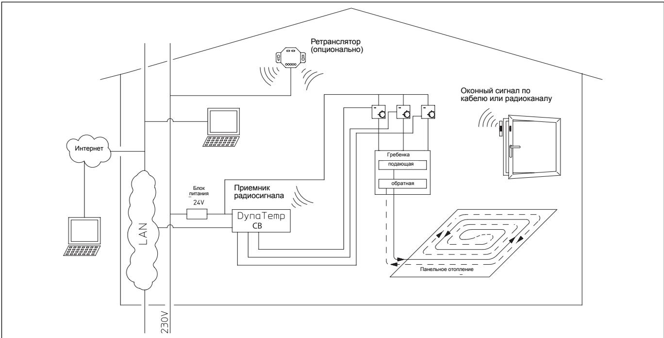
Система „DynaTemp CB“ с управлением электрическими комнатными термостатами для панельного отопления
