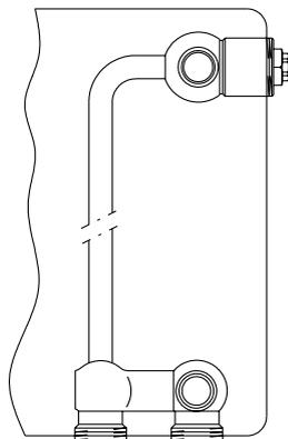
Узлы для подключения отопительных приборов к трубопроводу
