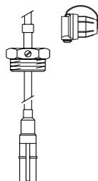
для батарейных емкостей по DIN 6620, форма В с нижним соединительным трубопроводом, для сварных емкостей, расположенных в подвальных помещениях по DIN 6625, длина кабеля 5,00 м
