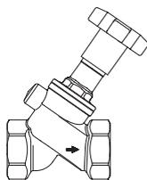
Не требующее обслуживания уплотнительное кольцо на головке вентилля и шпинделе, с невидимым шпинделем, метка „вентиль полностью открыт“, уплотнение седла клапана из PTFE, может применяться для систем водоснабжения
