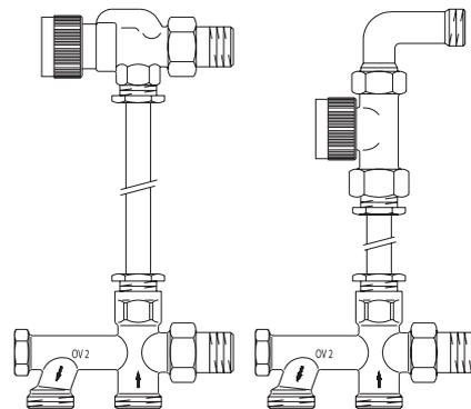
Наружная резьба G 3/4 по DIN V 3838 на присоединительных насадках „Duo“ для двухтрубных систем позволяет подключить медную, прецизионную стальную, полиэтиленовую и металлопластиковую трубу „Coripe“ Oventrop с помощью присоединительных наборов, стр. 1.80.
