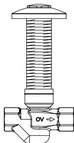
усиленная модель, с обеих сторон внутренняя резьба по EN 10226-1 для универсального подключения труб при скрытой установке под штукатуркой, с хромированной защитной крышкой и ключом с внутренним шестигранником SW5 для обслуживания
