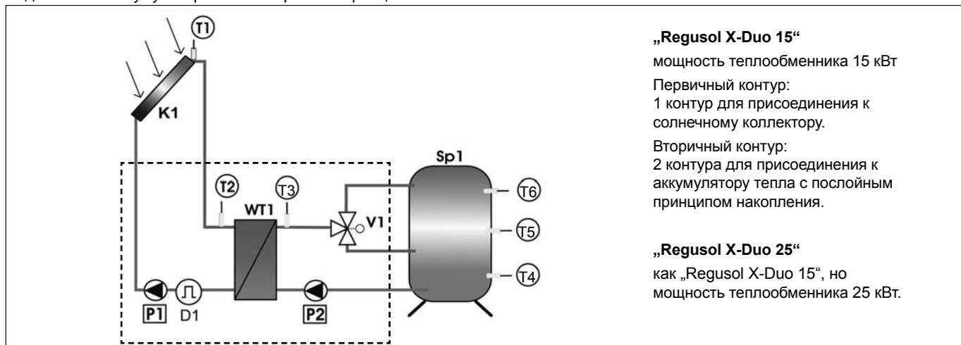
Подключение аккумулятора тепла с послойным принципом накопления
