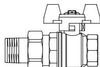
с одной стороны внутренняя резьба, с другой стороны ниппель с наружной резьбой и накидной гайкой (коническое уплотнение)
