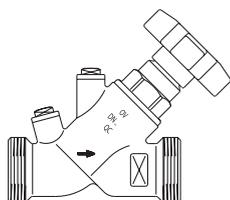
с обеих сторон внутренняя резьба, плоское уплотнение, по DIN ISO 228, с дренажными отводами G 1/4 перед и после седла клапана, закрыты заглушками, со встроенным обратным клапаном с малым давлением открытия, для универсального присоединения труб
