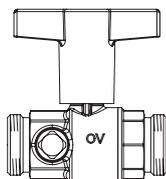
с обеих сторон наружная резьба, плоское уплотнение, по DIN ISO 228 с двусторонним расположением дренажных отводов G 1/4, закрыты заглушками, для универсального присоединения труб
