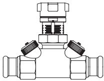
**„Нусосоп VPZ“ (преднастраиваемый, с пресс. соединением, из латуни, стойкой к выщелачиванию цинка) с плавной преднастройкой**
