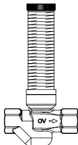
с обеих сторон внутренняя резьба по EN 10226-1 для универсального присоединения труб при скрытой установке, напр. под штукатуркой и внутри строительной конструкции, со специальной гильзой и колпачком для защиты/обслуживания фиксированная настройка температуры 57 °C ± 1 °C
