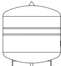
**Мембранный расширительный бак „Solar“ с приваренными ножками, HP R 1**
