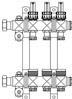
**„Multidis SF“ гребенка из нержавеющей стали 1" для панельного отопления со встроенными ротаметрами 0-5 л/мин. на подаче**
