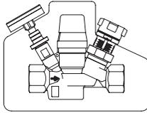
Термостатические вентили с фиксированным остаточным расходом „Aquastrom T plus“
