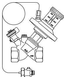
**„Hydromat DTR“ (регулирование перепада давления, резьбовой, бронзовый)**
